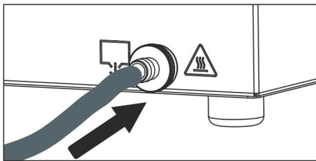
Fig. 73 : Insertion du flexible
