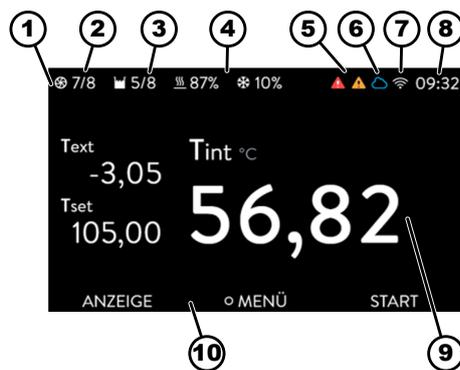
Fig. 24 : Fenêtre de base avec barre d'état, affichage de la température et barre des touches programmables
