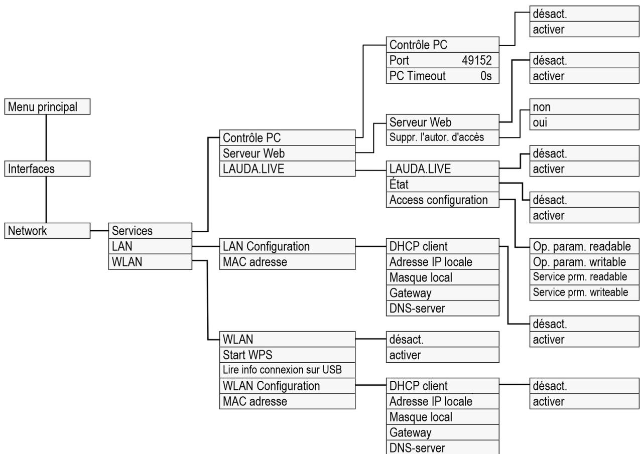
Fig. 45 : Menu de l'interface WLAN
