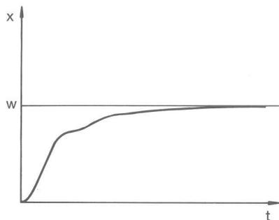
Fig. 58 : Paramètres de régulation  $T_n$  et  $T_v$  trop grands
