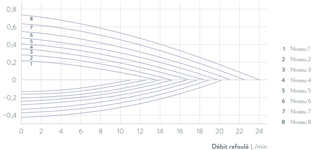
Fig. 80 : Caractéristique de la pompe Universa MAX avec pompe refoulante-aspirante (pompe Varioflex)
