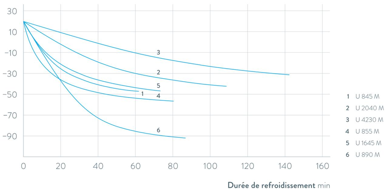
Fig. 77 : Courbes de refroidissement pour cryothermostats Universa MAX
