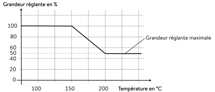
Fig. 61 : Limitation dynamique de la puissance de chauffe
