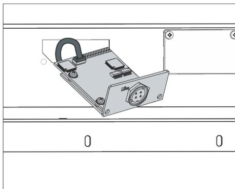
Fig. 22 : Raccorder le module d'interface (schéma de principe)
