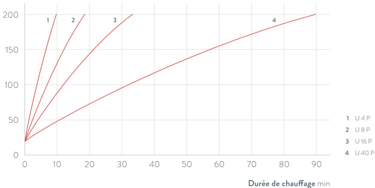
Fig. 74 : Courbes de montée en température pour thermostats chauffants Universa PRO
