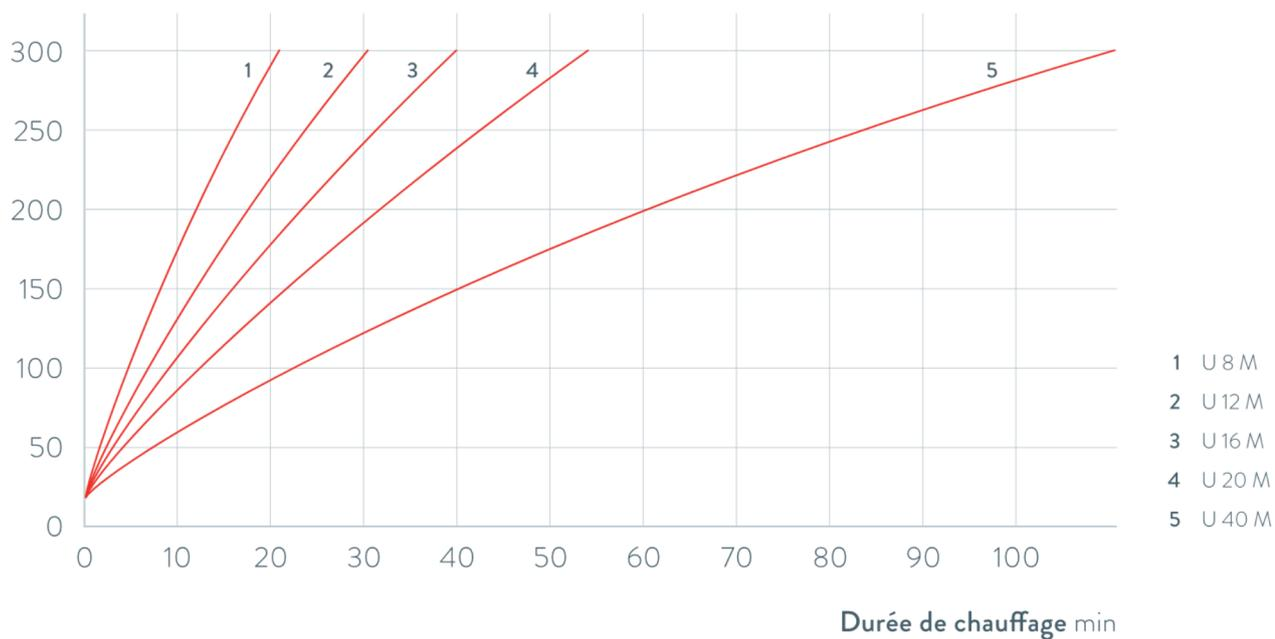
Fig. 75 : Courbes de montée en température pour thermostats chauffants Universa MAX
