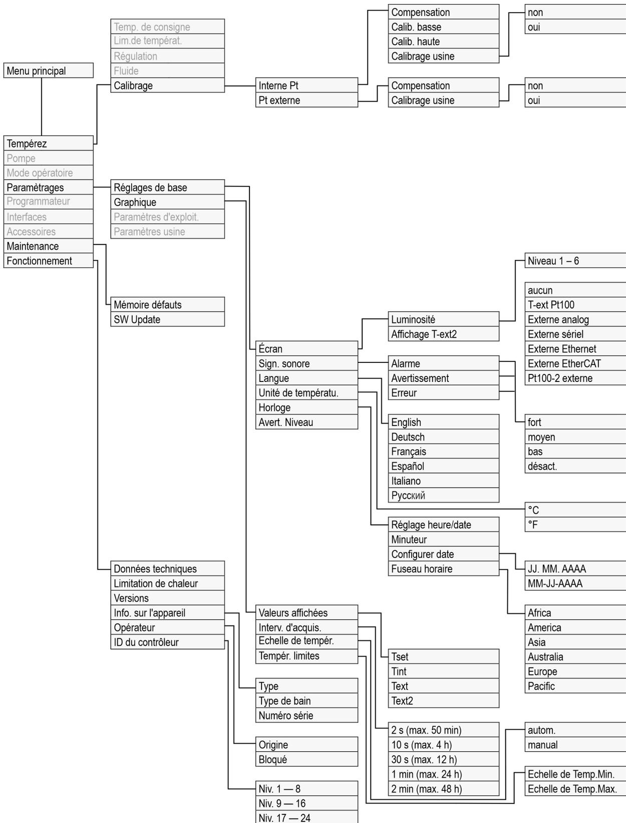
Fig. 49 : Structure du menu partie 2, pour MAX et PRO
