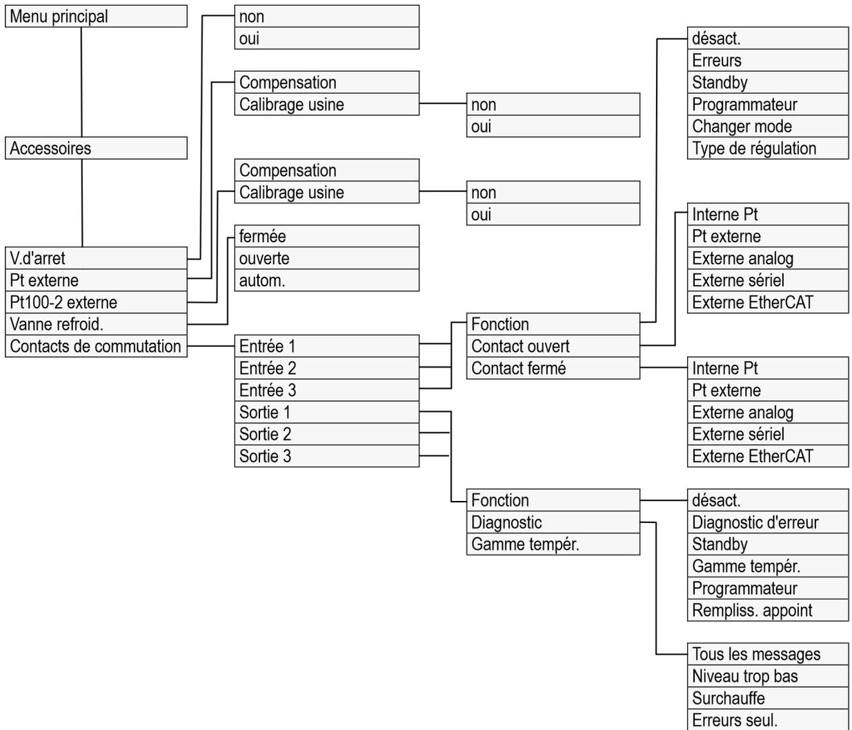
Fig. 52 : Structure du menu partie 5, pour MAX et PRO
