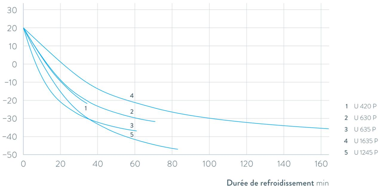
Fig. 76 : Courbes de refroidissement pour cryothermostats Universa PRO
